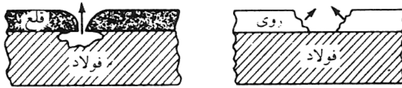
شکل ۲-۲۵ خوردگی گالوانیکی در محل‌های آسیب دیده در پوشش روی و قلع روی فولاد
